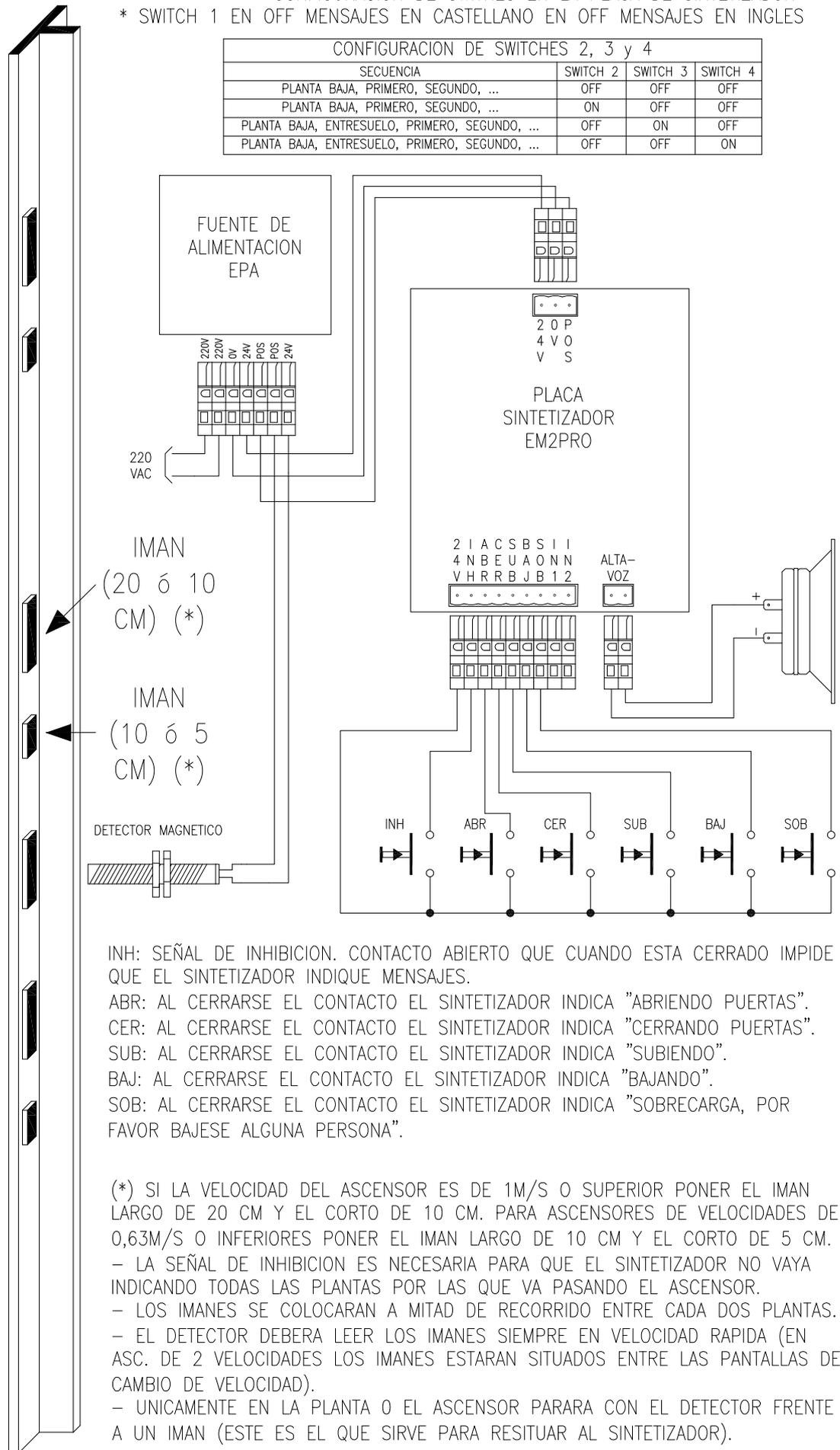
INH: SEÑAL DE INHIBICION. CONTACTO ABIERTO QUE CUANDO ESTA CERRADO IMPIDE QUE EL SINTETIZADOR INDIQUE MENSAJES.
